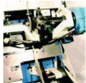
*Vorfräс- und Feilfräсstationen befinden sich bei den PÜTSCH®-Messeraufbereitungssystemen MSA-S in einer Maschine. Die Schnitzelmesser werden in nur einem Durchgang geschärft.*
